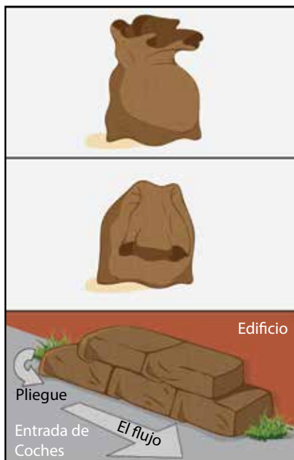
Fig. 4 - Colocación de Bolsas de Arena
