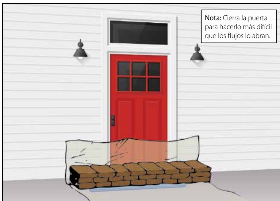
Fig. 12 - Sellado de Puerta
